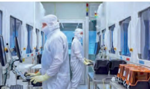
Im Reinraum der Bestandsfabrik werden Mikrochips auf 200 mm-Wafern hergestellt.
